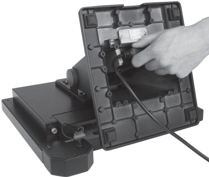
Afb. 1: Steek de stroomkabelstekker in de stroomkabelbus.
