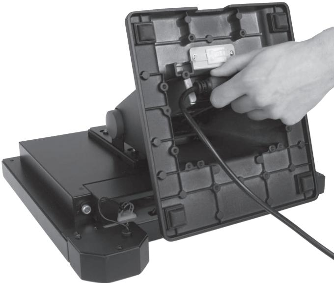
Abb. 1: Netzkabelstecker in Netzkabelbuchse stecken
